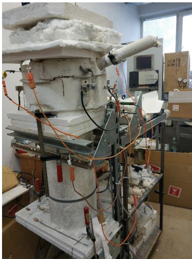
Rys. 27. Kompletne stanowisko badawcze do przygotowywania małych próbek witrifikatu o regulowanej wysokości spadku próbki. [aut.]
