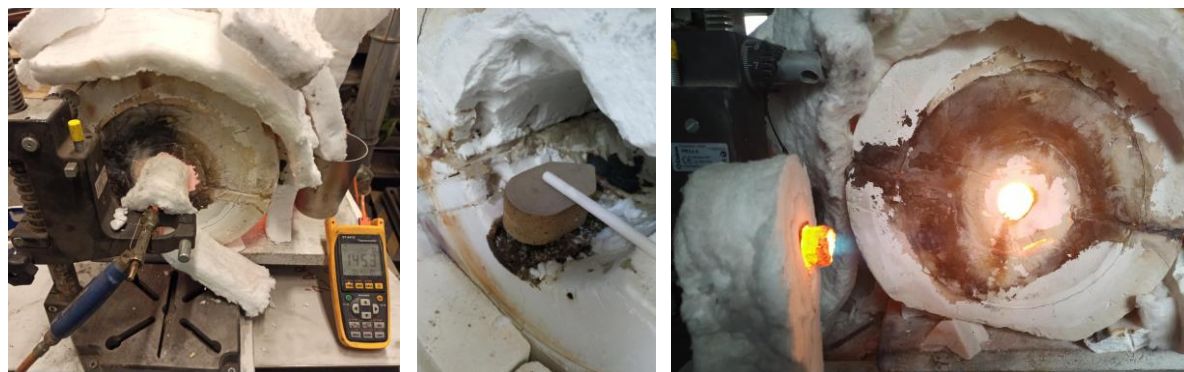
Rys. 28. Od lewej: stanowisko z palnikiem - LPG-powietrze; załadunek próbki; odstawienie i chłodzenie próbki. [aut.]
