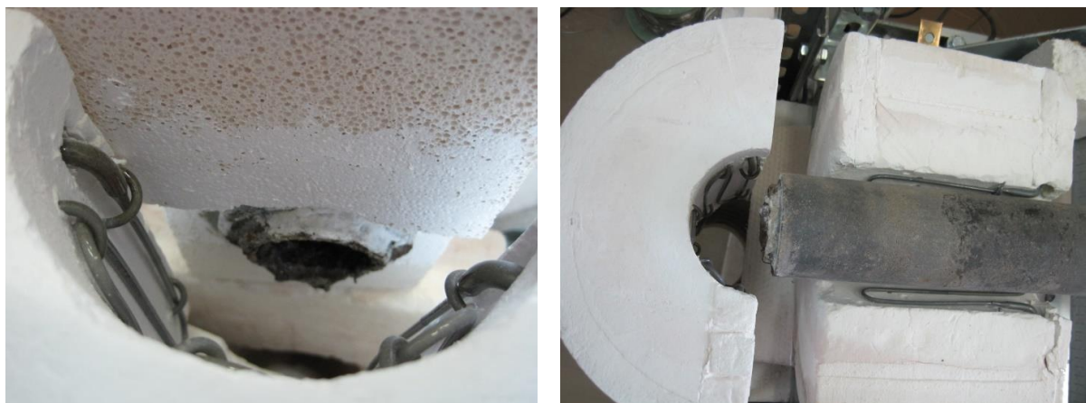
Rys. 24. Dodatkowe podgrzewanie wylotu za pomocą trzeciej grzałki superkantowej® [39]
