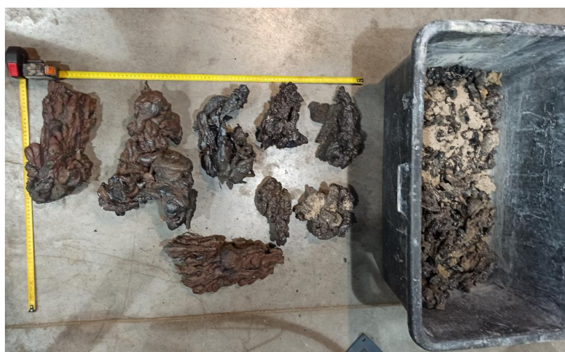
Rys. 55. Witrifikat pozyskany z oczyszczania reaktora – 47kg [aut.].
