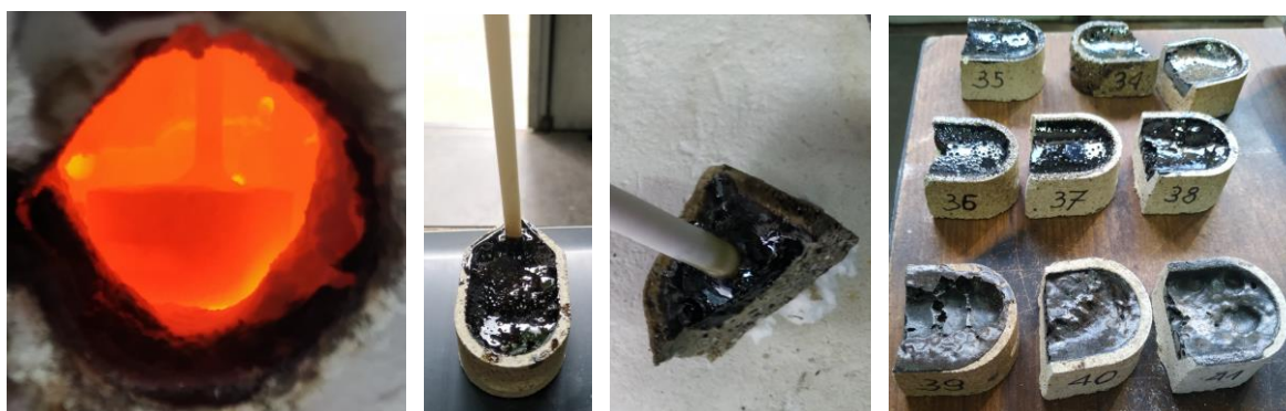
Rys. 31. Pomiar temperatury za pomocą termopary zanurzonej w wityryfikacie – od lewej: próbka po odstawieniu palnika; próbka z termoparą po schłodzeniu; odcięcie termopary; próbki gotowe do badań. [aut.]
