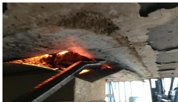
Rys. 53. Pierwszy witrifikat pozyskany z instalacji CO 2 na stalowym zamknięciu komory [aut.].
