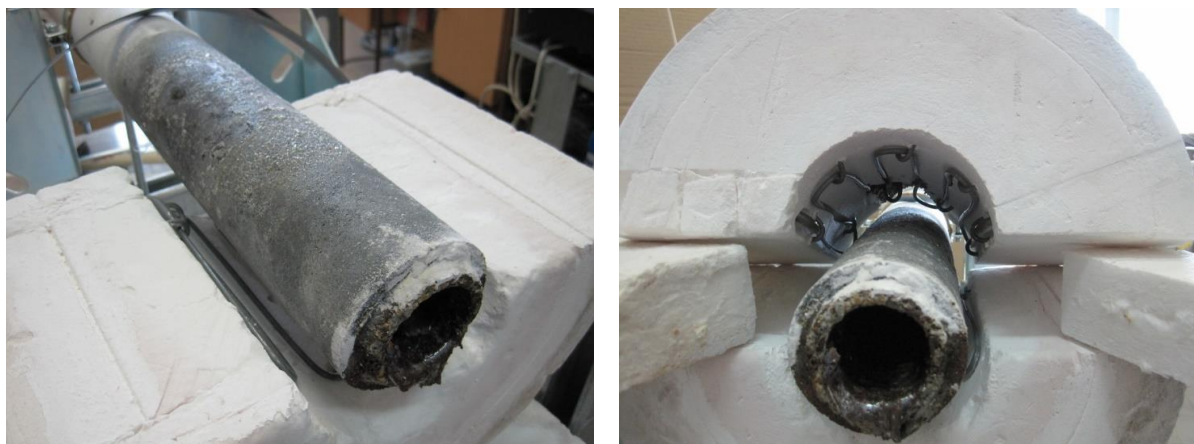
Rys. 23. Widok stanowiska – grzałka dolna (z lewej); grzałka górna (z prawej).[39]
