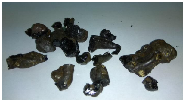
Rys. 53. Pierwszy witrifikat pozyskany z instalacji CO 2 na stalowym zamknięciu komory [aut.].
