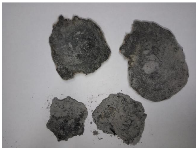
Rys. 39. Popiół z kotła rusztowego z procesu oczyszczania spalin wodorotlenkiem sodu[aut].
