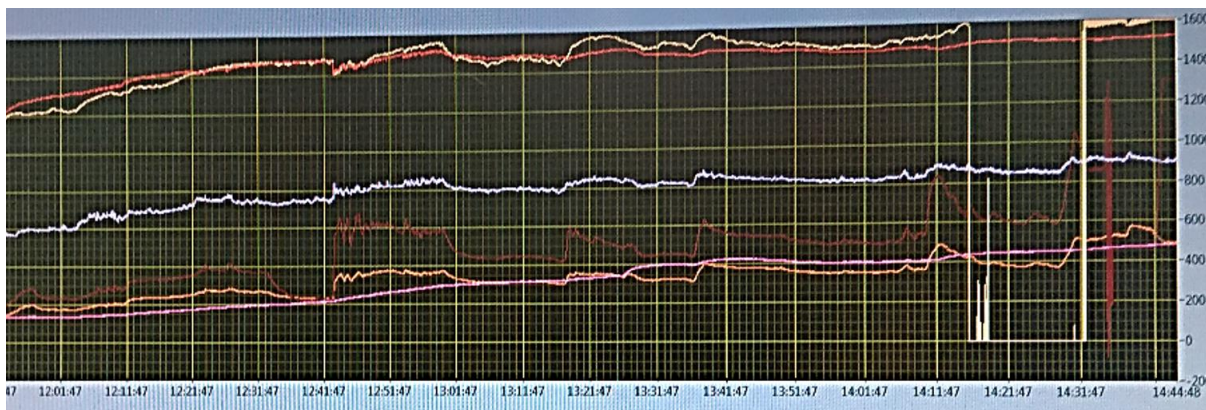
Rys. 52. Przebieg temperatur w reaktorze CO 2 po wstępnym wygrzaniu do osiągnięcia temperatury 1600°C i rozpoczęciu procesu witrifikacji [aut.].
