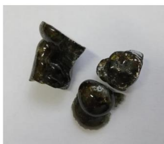
Rys. 40. Próbki witryfikatów pochodzące z popiołu lotnego z węgla kamiennego spalonego w kotle fluidalnym [aut.].
