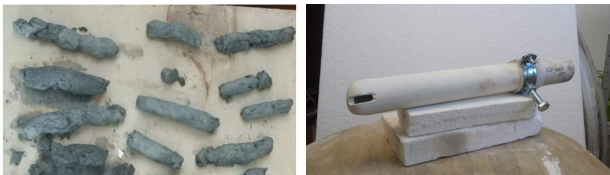
Rys. 25. Modyfikacje- od lewej: zmiana sposobu przygotowywania popiołu do postaci brykietów[aut]; wymienna, obrotowa rura topienia ze szczeliną umożliwiającą wypływ stopionego popiołu po obrocie. [40]
