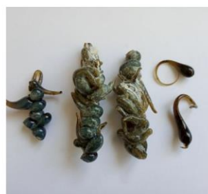
Rys. 40. Próbki witryfikatów pochodzące z popiołu lotnego z węgla kamiennego spalonego w kotle fluidalnym [aut.].
